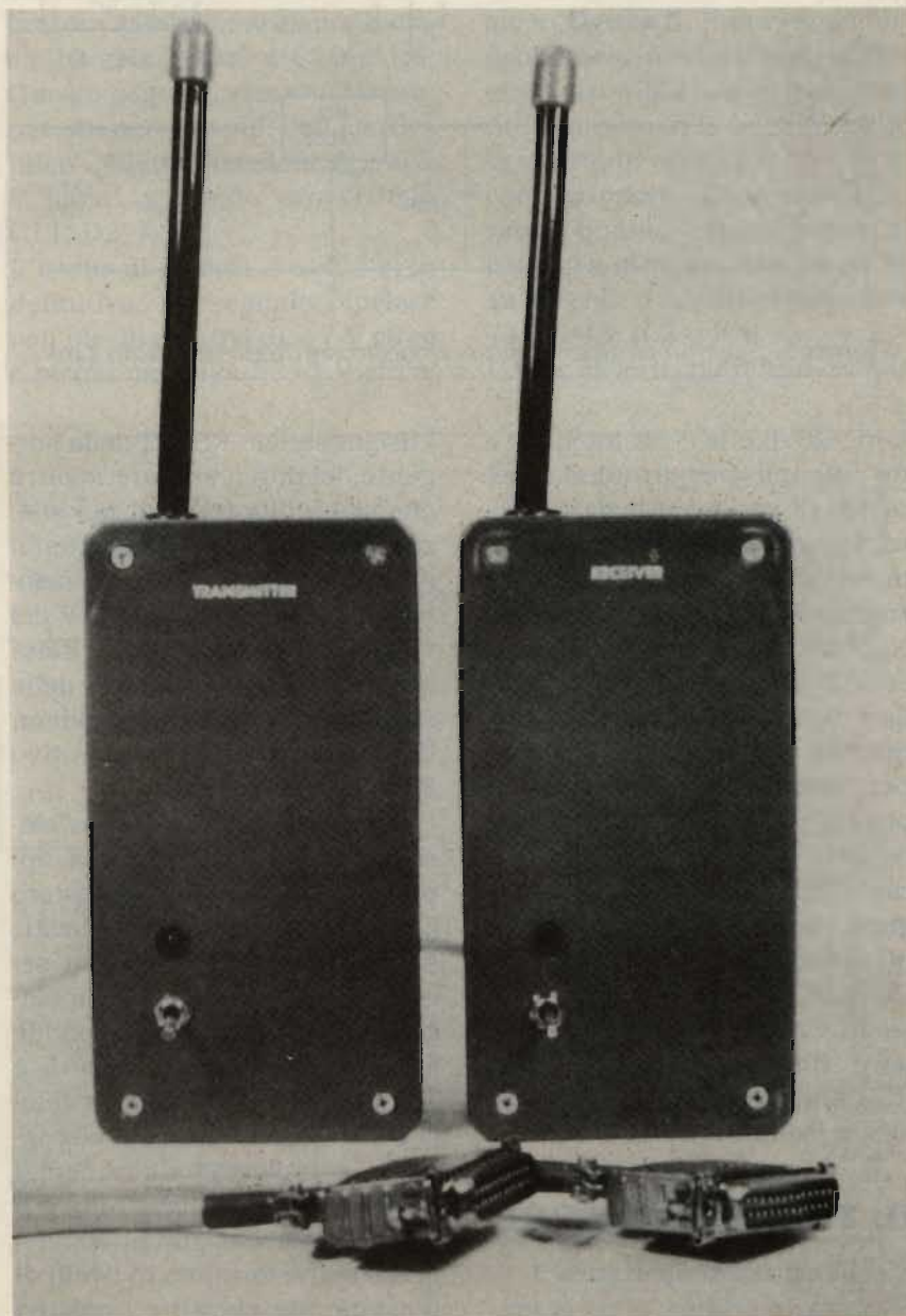
Le due unità del Data Link a montaggio ultimato.
